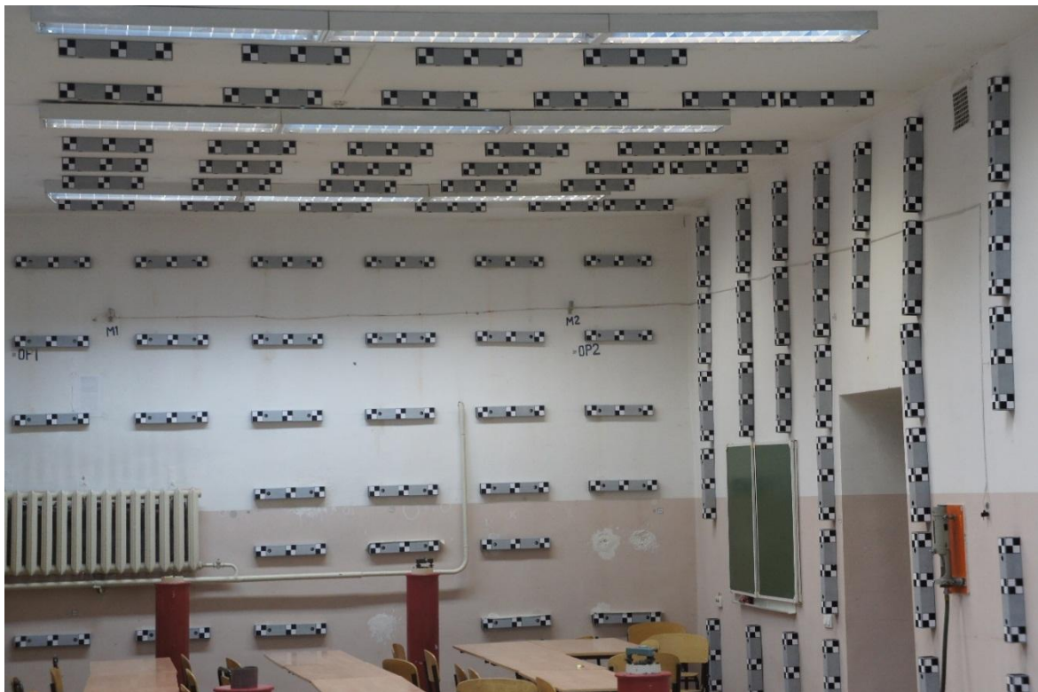
Рис. 3. Калибровочный тест-объект СГУГиТ
