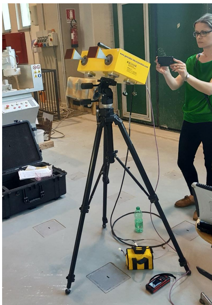
Наземный интерферометр IBIS-FS (International Summer School-2018, Italy)
