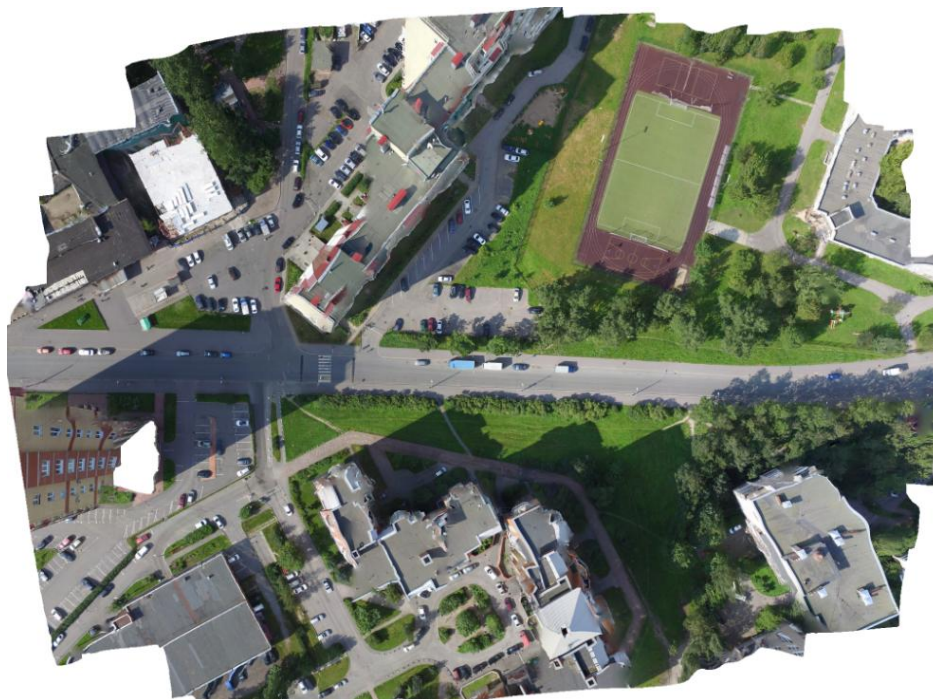
Рис. 4. Ортофотоплан, полученный в Agisoft PhotoScan
